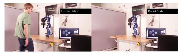
Fig. 6: Top-screen expressing «Human-In-Workspace» (left) or «Robot-Locked» (right)
